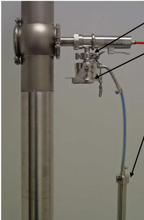
Der Stericap wird mit einer Klampe am Probenehmer befestigt.
