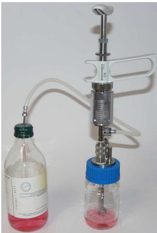
Die Flasche wird im Labor unter sterilen Bedingungen ohne Öffnung der Flasche mit Nährlösung gefüllt (Beimpfung mittels Selbstfüllspritze).
