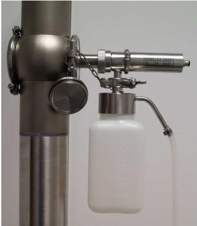
Abfüllung in sterile Kunststoffflaschen, die direkt im Stericap eingeschraubt werden.
