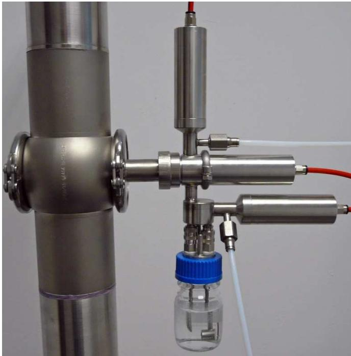
Die Flasche wird unter sterilen Bedingungen am Probennehmer angedockt und anschließend automatisch beprobt .
