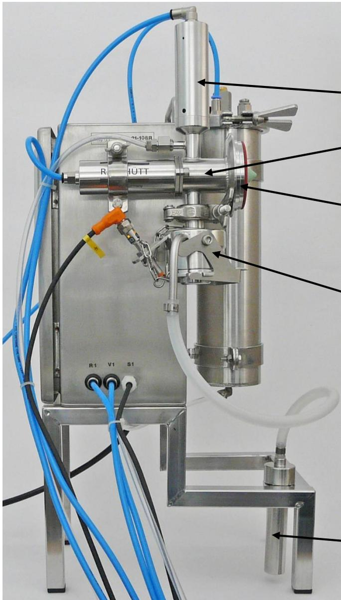
Die Abbildung zeigt das Reinigungsventil im Einsatz an einem tragbarem System.
